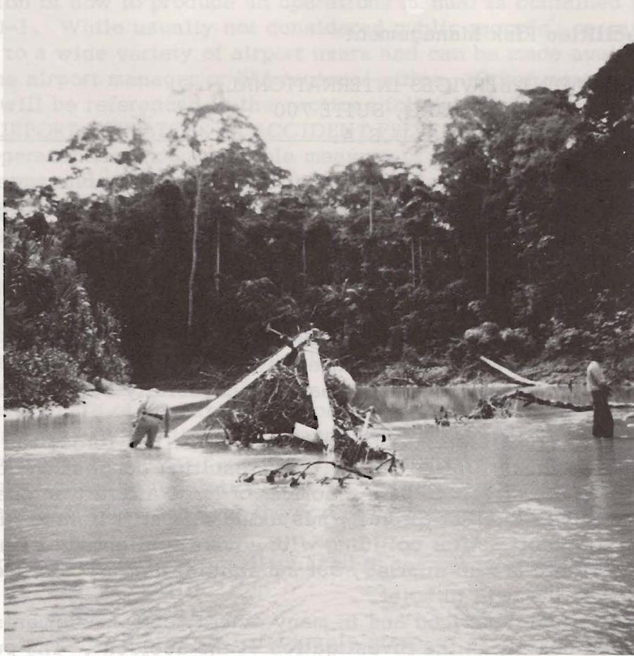
El núcleo del rotor principal se rompió dando como resultado que las palas rotaran en posición de aproximadamente 60 grados de su posición normal, las que destrozaron las ramas del árbol y la cabina del helicóptero, lesionando mortalmente al piloto.
