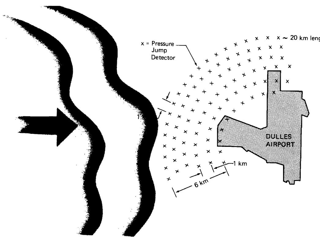
FIGURE 10. LOCATION OF PRESSURE JUMP DETECTORS AROUND DULLES
